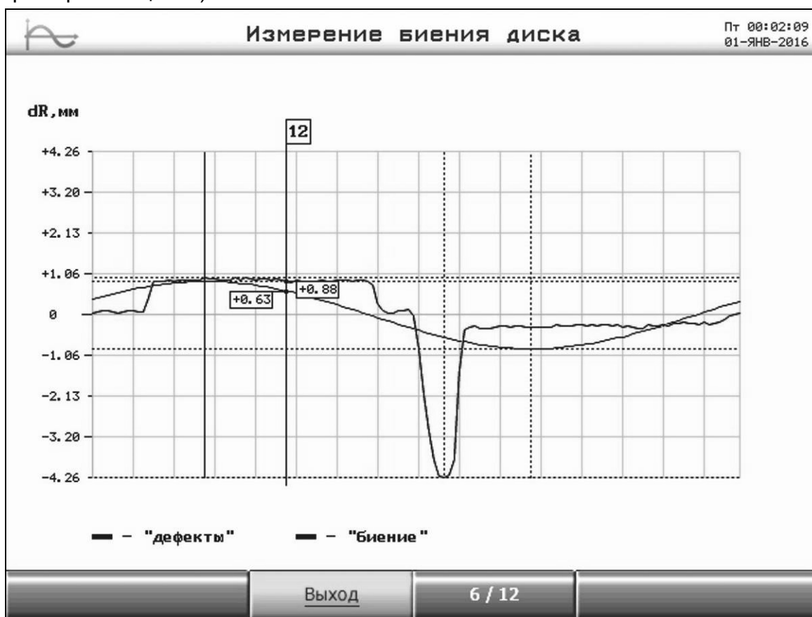
Рисунок 7.6 – Окно измерения биений диска
