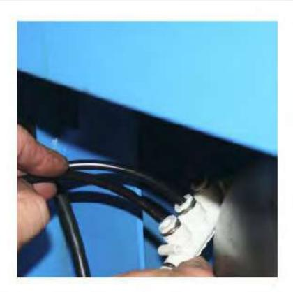
ПОДКЛЮЧИТЕ ПОДАЧУ ВОЗДУХА К ШИНОМОНТАЖНОМУ СТАНКУ И ПРОВЕРЬТЕ ПЕНВМОЦИЛИНДР НА ДВИЖЕНИЕ ВВЕРХ/ВНИЗ.
